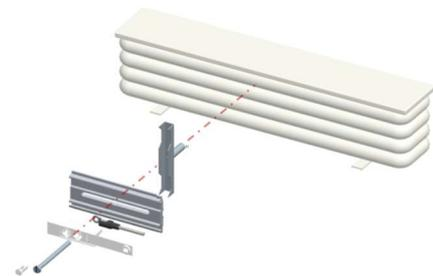
Darstellung 4: Gliederheizkörper aus Rohren – Fensterbankradiatoren
