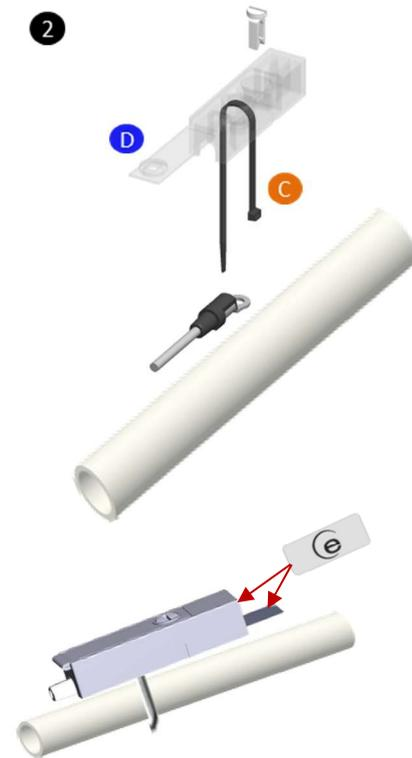
Abbildung 35: Klebplombe zur Befestigung an Fernfühlergehäuse und Heizrohr
