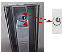
Abbildung 31: Klebeplombe für Fernfühlergehäuse: Sicherung auf Alu-Wärmeleiter
