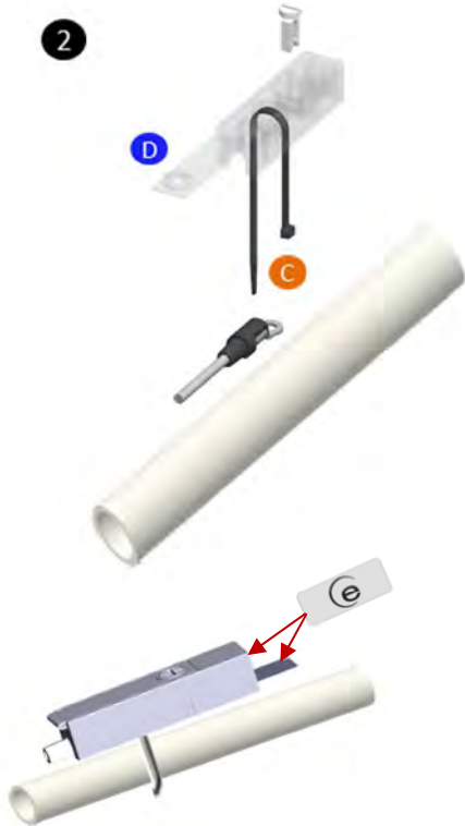
Abbildung 35: Klebplombe zur Befestigung an Fernfühlergehäuse und Heizrohr
