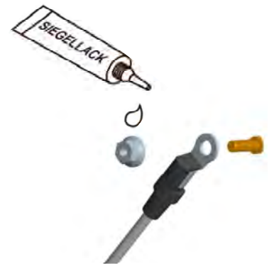
Abbildung 14: Fernfühlersicherung mit Siegelack bei Montage mit einem Schweißbolzen
