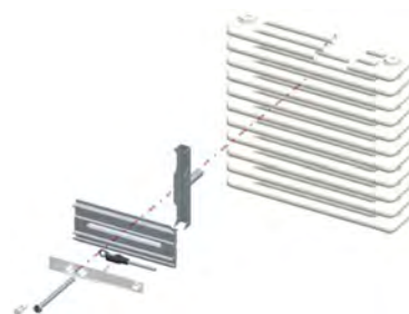
Darstellung 2: Gliederheizkörper aus Rohren – 90° gedreht eingebaut
