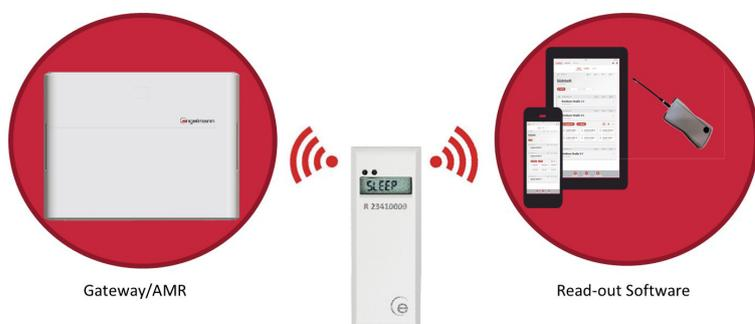
Même si vous utilisez encore la radiorelève, l'intégration transparente dans l'écosystème Engelmann facilite le passage à la télérelève (AMR/gateway), étant donné qu'aucune adaptation (modification de la configuration) du répartiteur de frais de chauffage n'est nécessaire.
