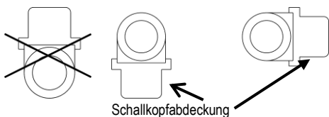
Abb. 4: Empfohlene Einbaulage bei Kältezählung
